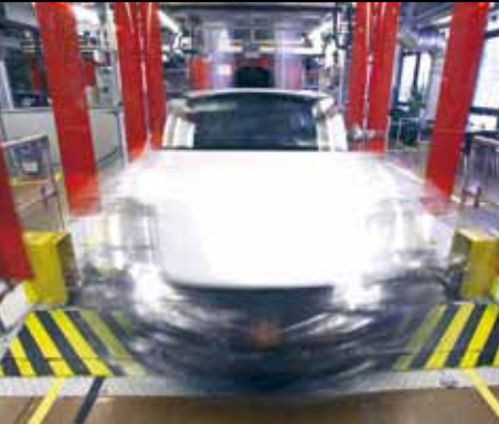
Ein Porsche Cayman S auf dem Fahrwerkprüfstand.
