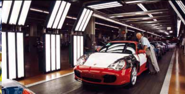
Im Lichttunnel wird die Lackierung geprüft.
